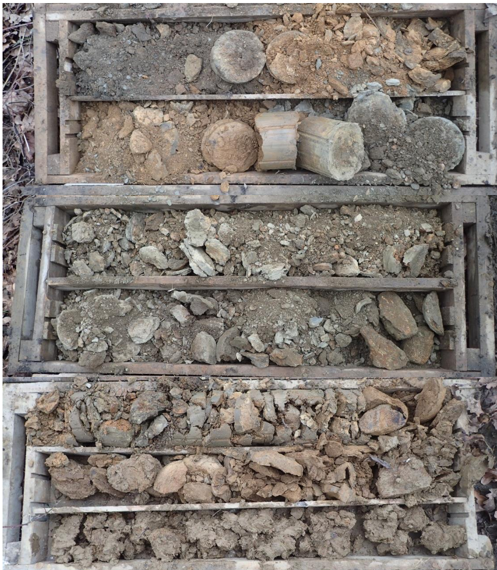
Foto 5: Profil inženýrsko-geologického vrtu J18
